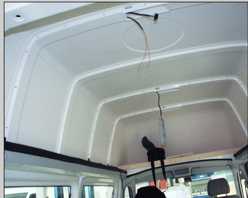
neu (Kabel im Spriegel versteckt)
